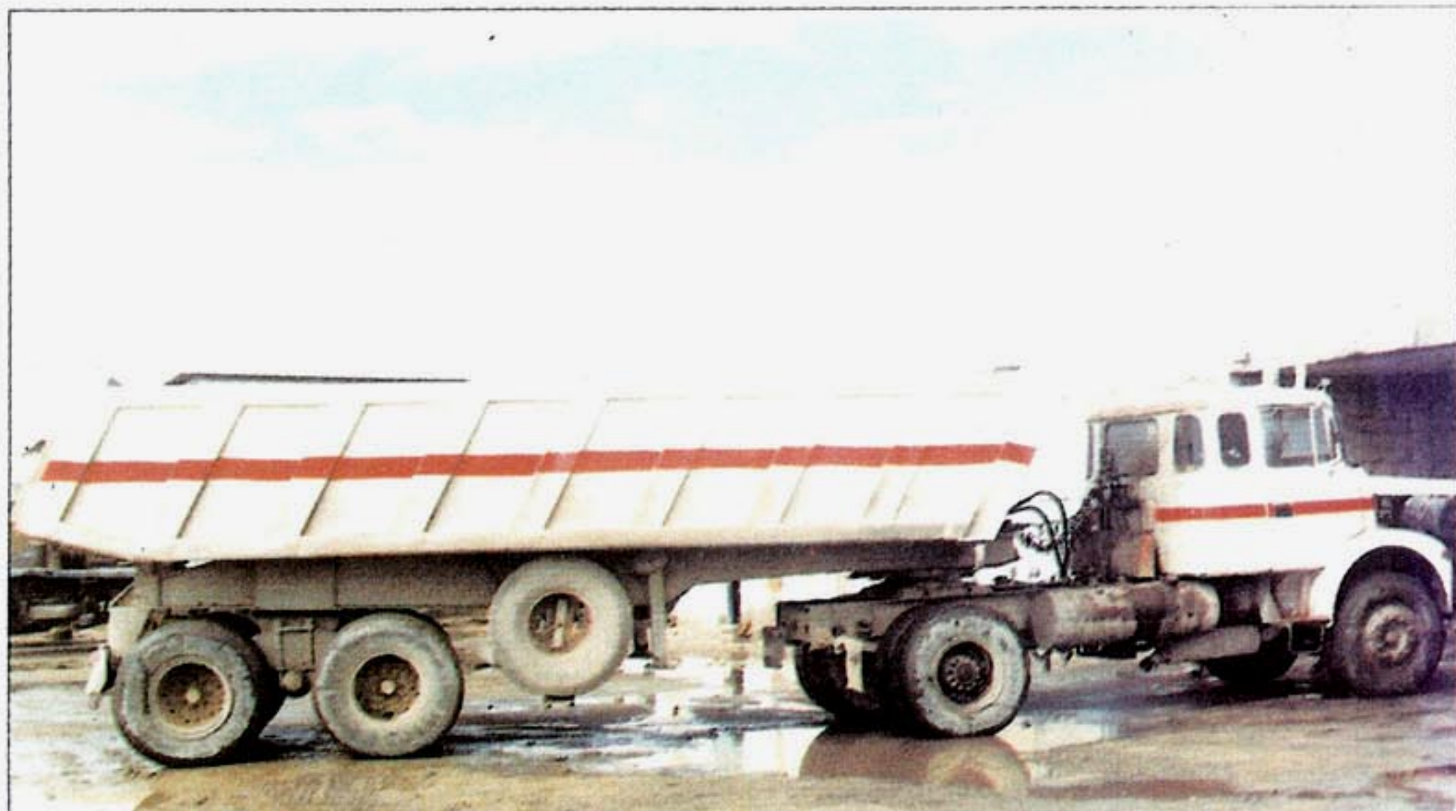
Semi-remorque benne, transport d'argile, gypse et clinker.
